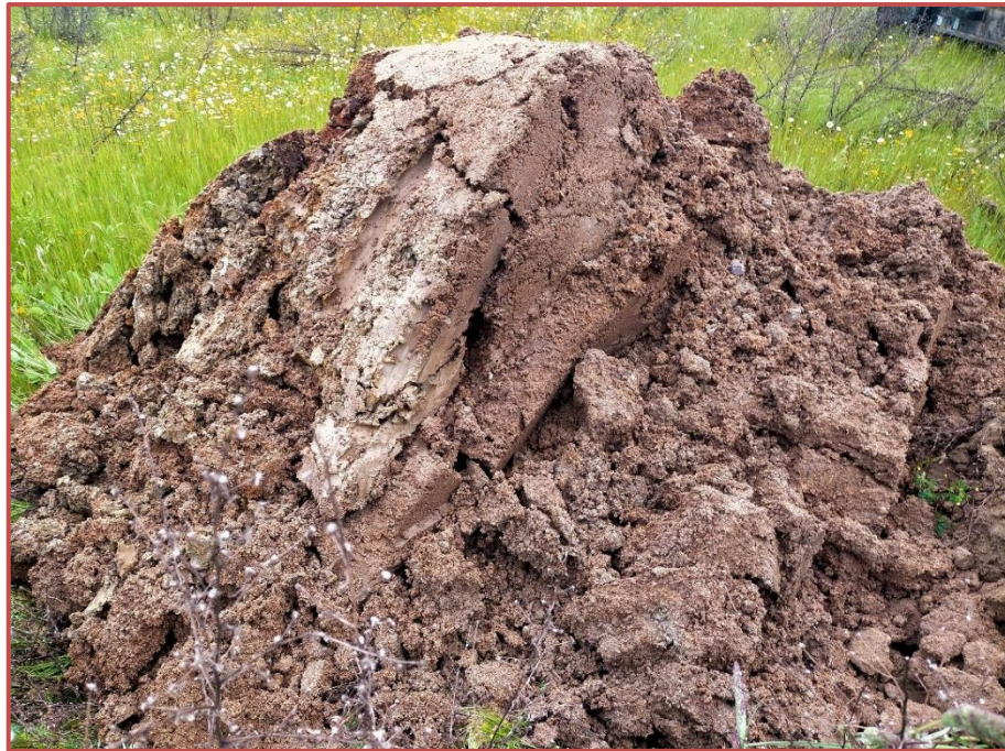
FIGURA 7 – Livello A1, deposito alluvionale in facies argilloso-sabbiosa
