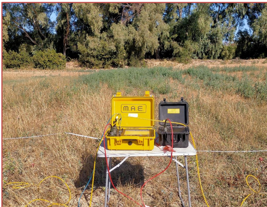
FIGURA 3- Posizionamento della strumentazione per l'esecuzione della prospezione geofisica a rifrazione
